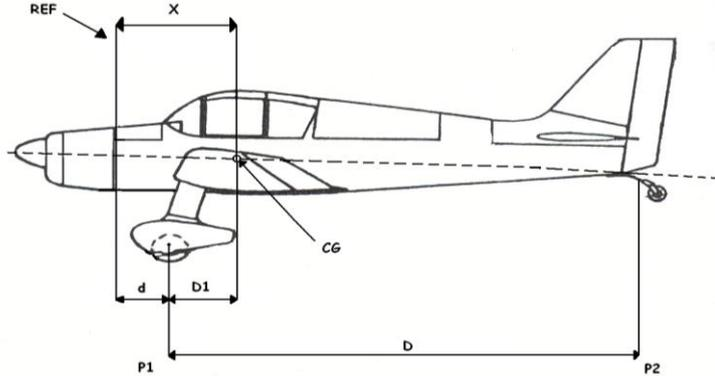
Mise à niveau = Plancher soute à bagages
