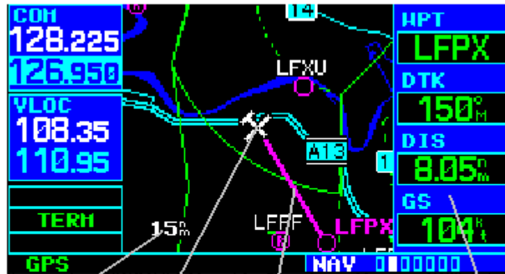
Niveau de zoom (distance entre le haut et le bas de la carte en nm) Position de l'avion sur la carte Tracé du plan de vol actif (en magenta, la branche active) Données de navigation
